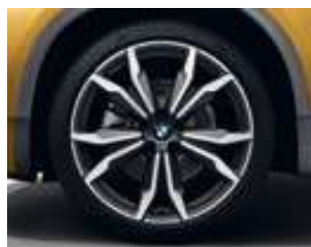
Jantes alliage léger 20" (51 cm) style 717 M à rayons doubles, "Orbitgrau" mat / RSC 8 J x 20 / pneus 225/40 R 201
