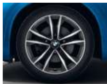
Jantes alliage léger 19" (48 cm) style 715 M à rayons doubles, avec pneumatiques Performance, "Orbitgrau" 8 J x 19 / pneus 225/45 R 192
